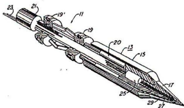
A patente dos EUA da máquina de perfuração de túnel nuclear
